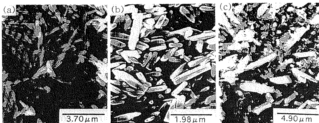
Fig.5 種々の縮合リン酸カルシウムゲル溶液の水熱反応 (140°C, 1d) により生成した水酸アパタイトの SEM 写真
