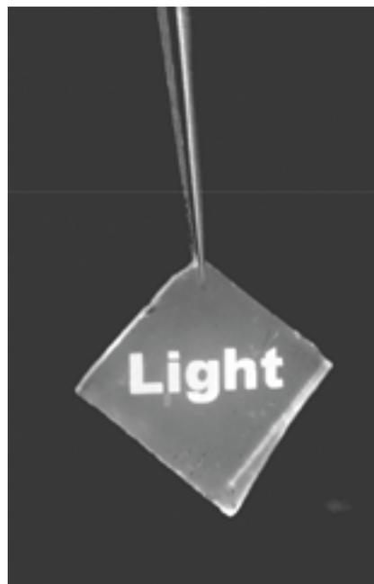
図5 フォトマスクを通して部分的に光エッチングした $\text{SiO}_2/\text{CdSe}$ (film)の発光像。励起光: 350 nm。
